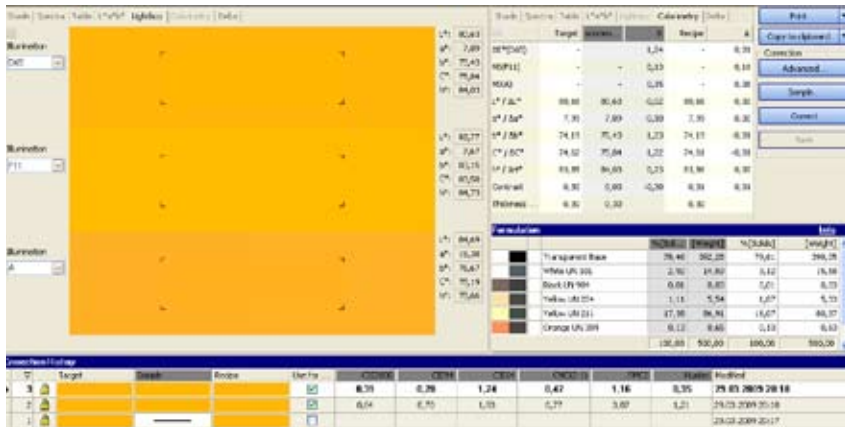
Pantalla de corrección de recetas con representación del objetivo, muestra y predicción bajo 3 fuentes de luz para visualizar metamerismo y constancia del color.
