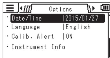
4. Presione la tecla **UP** o la tecla **DOWN** para seleccionar **[Date/Time]** y luego presione la tecla **ENTER**.
