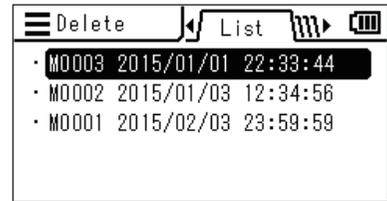
Puede verificar los detalles del elemento seleccionado presionando la tecla **[RIGHT]**. Puede verificar la condición de medición, el patrón, el valor de calibración de usuario, etc. presionando la tecla o la tecla **[INFO]**. Cuando no se han almacenado datos, se muestra "Measurement data not found." (no se han encontrado datos de medición.) Cuando no hay datos de patrón o calibración de usuario almacenados, se muestra como "- - -".
