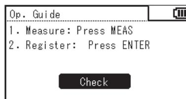
**6. Presione el botón de medición para realizar la medición. Cuando se muestre el valor medido, presione la tecla **ENTER**.**
