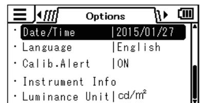
4. Se muestra la pantalla para seleccionar si se muestra o no el alerta de calibración periódica. Presione la tecla **[UP]** o la tecla **[DOWN]** para seleccionar **[ON]** (habilitado) u **[OFF]** (deshabilitado) y luego presione la tecla **[ENTER]**.
