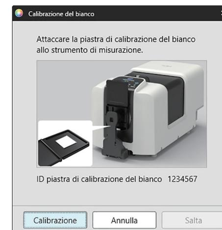
3. Se in Condizioni di misurazione è selezionato Colore e brillantezza, appare la finestra di dialogo Calibrazione della brillantezza. Seguire le istruzioni della finestra di dialogo e fare clic su [Calibrazione] per eseguire la calibrazione della brillantezza.
