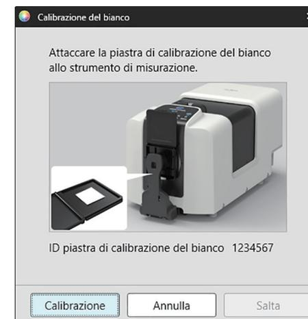
Se lo strumento non supporta le misure di lucentezza o se Colore e brillantezza non è selezionato in Condizioni di misurazione, la calibrazione è completa.
