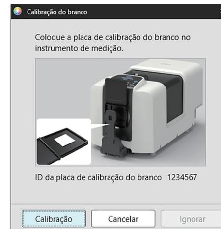
Se o instrumento não der suporte a medições de brilho ou se Cor & Brilho não estiver selecionado em Condição de medição, a calibração está concluída.
