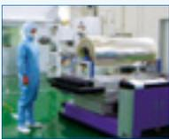
Films en triacétate de cellulose (TAC) pour les plaques polarisantes des écrans à cristaux liquides (LCD)
