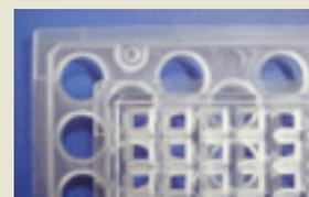
Plateaux utilisés pour les dépôts de vapeur des lentilles réalisés à partir de déchets plastiques de production.
