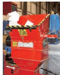
Machine de pulvérisation de mousse de polystyrène
