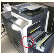
Utilisé pour le couvercle (transport vertical)
