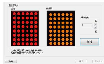
如果各点呈黄色，则表示RANGE 7/5离校准图太远。此时，请将RANGE 7/5主机向校准图移近3至5mm。
