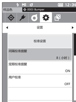
2 表示信息显示时间的数字的上下两侧显示▲▼。使用 [▲] [▼] 键指定数值。
