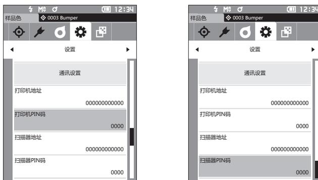
2 PIN码的数字的上下两侧显示▲▼。使用 [▲] [▼] 键指定数值。要在数值间移动光标时，使用 [◀] [▶] 键。
