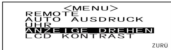
Der auf dem LC-Display angezeigte Inhalt wird jedes Mal umgekehrt, wenn
