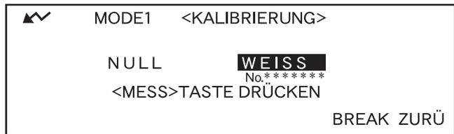
**4 Platzieren Sie das Messgerät auf die korrekte Weißkalibrierplatte (z.B. die Kalibrierplatte, deren Nummer auf dem Bildschirm angezeigt wird).**
