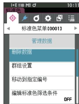
2 使用 [◀] [▶] 键将光标移至“确定”，按下 [确定] 键，将删除数据。
