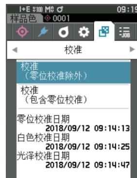
2 使用 **[▲] [▼]** 键，将光标移至“校准（包含零位校准）”，然后按下 **[确定]** 键。
