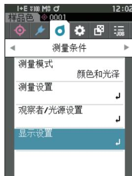
2 使用 [ $\blacktriangleup$ ] [ $\blacktriangledown$ ] 键，将光标移至“显示设置”，按下 [确定] 键。
