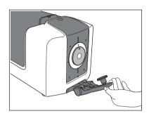
2 如图所示,将样品架插入白色校准板背面的凹处,用样 品架夹住白色校准板。
