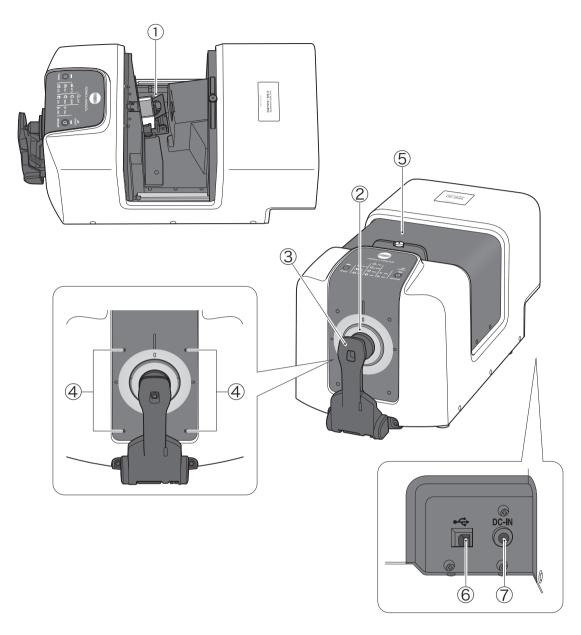
ø11 mm(MAV)、ø7 mm(SAV)目标罩中选择合适的安装到本仪器
