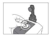
2 将样品架插进白色校准板背面的凹处,用样品架压住。
