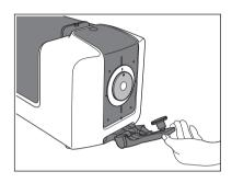
2 如图所示,将样品架插入光泽度校准板背面的凹处,用 样品架夹住光泽度校准板。
