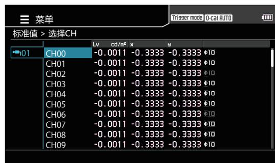
**6** 按下 [ENTER] 键。显示标准值测量弹窗画面和测量 “MEAS” 按钮，再次按下 [ENTER] 键进行测量。
