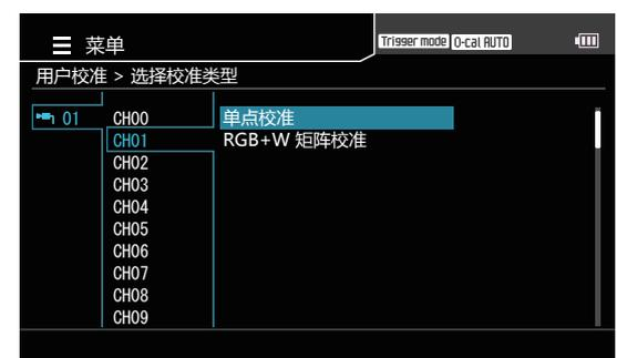
**7** 显示单点校准的弹窗画面，按下 [ENTER] 键进行测量，显示测量值后按下 [ENTER] 键保持值。
