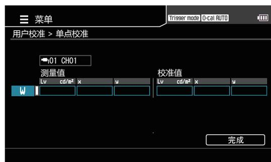
**10** 重复步骤 8、9，设定校准值的数值后移动至 [完成]，按下 [ENTER] 键确定。
