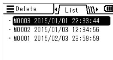
Vous pouvez voir les détails de l'élément sélectionné en actionnant la touche **RIGHT**. Vous pouvez contrôler la condition de mesure, la cible, la valeur de calibration utilisateur, etc., en appuyant sur la touche **INFO**. Lorsqu'aucune donnée n'a été enregistrée, « Measurement data not found. » est affichée. Lorsqu'aucune donnée de cible ou de calibration utilisateur n'est enregistrée, « - - - » est affiché.
