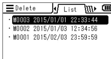
È possibile visualizzare i dettagli dell'elemento selezionato premendo il tasto **[RIGHT]**. È possibile controllare la condizione di misurazione, il target, il valore di calibrazione utente ecc. premendo il tasto **[INFO]**. Quando non è stato memorizzato alcun dato, è visualizzato "Measurement data not found.". Quando non è memorizzato alcun dato target o di calibrazione utente, è visualizzato come "- - -".
