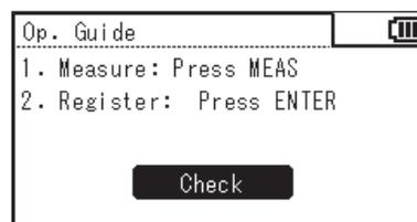
**6. Premere il pulsante di misurazione per eseguire la misurazione. Quando è visualizzato il valore misurato, premere il tasto **ENTER**.**
