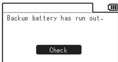
Lesen Sie, wenn das Messgerät nach Auftreten des Fehlers nicht wiederhergestellt werden kann und die folgende Meldung anzeigt, den Abschnitt „Prüfen auf Störungen“ weiter hinten in diesem Handbuch.
