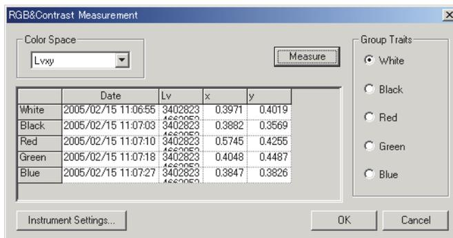
Exhibición de muestra de color de la fuente luminosa, medición en el modo RGB y contraste
