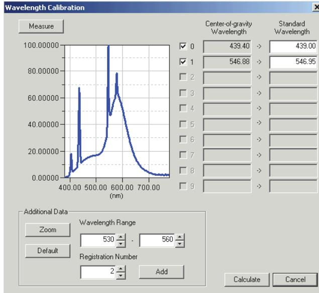
**3-3.** Bajo Additional Data, en los cuadros de combinación Wavelength Range, especifique el rango de longitudes de onda para calcular la longitud de onda de gravedad.
