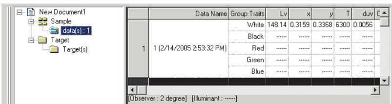
Ejemplo de exhibición del color de la fuente luminosa, medición en el modo RGB y contraste
