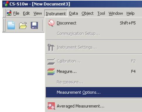
2. Especifique los parámetros para Interval Measurement y Averaging Measurement.
