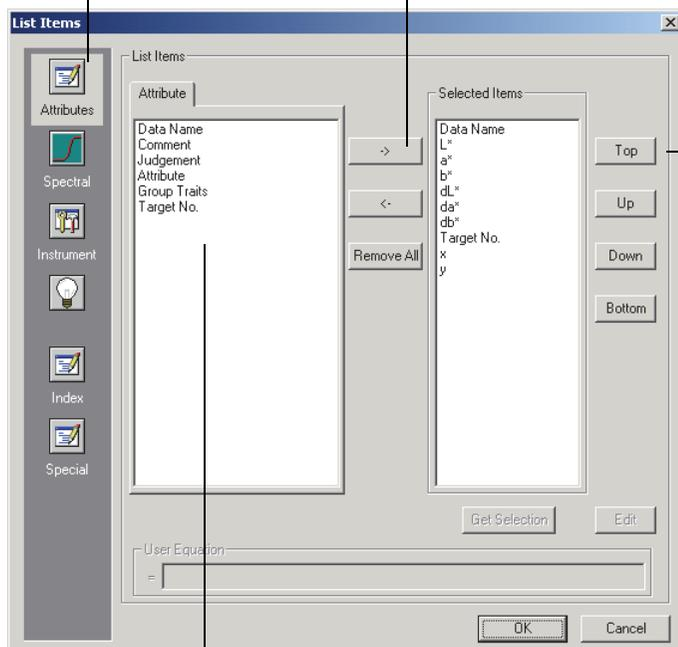
Usted puede modificar el orden en el cual se exhiban los elementos en la ventana de listado. El elemento situado en la parte superior de este panel es exhibido en el costado izquierdo de la ventana de listado. Para cambiar el orden, seleccione el elemento en el panel Elementos seleccionados y haga clic sobre el botón adecuado.
