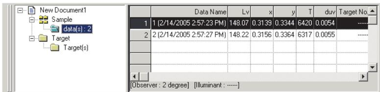
Ejemplo de exhibición del color de la fuente luminosa, medición en el modo normal
