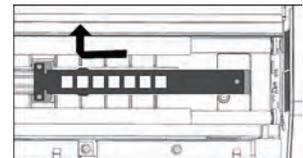
**11 Insérer la bande de tuiles n° 2 comme illustré à l'étape 5 ci-dessus.****12 Fermer le couvercle du FD-9.****13 Cliquer sur [ Mesure ]. Le message « Mesure en cours... » s'affiche et le FD-9 va mesurer la bande de tuiles.****14 Quand la mesure de la bande de tuiles n° 2 est terminée, la valeur de référence mesurées s'affichent dans le tableau Valeur de standard.**
