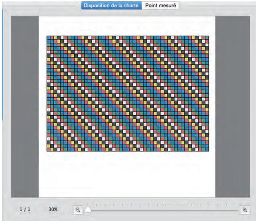
L'onglet Disposition de la charte montre une image couleur des patches sur la charte sélectionnée ou la mesure sélectionnée.
