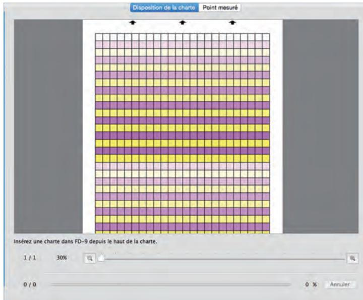
L'onglet Disposition de la charte montre une image couleur des patches sur la charte sélectionnée ou la mesure sélectionnée.
