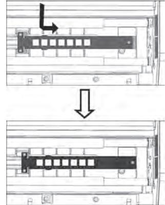
**6 Fermer le couvercle du FD-9.****7 Cliquer sur [ Mesure ]. Le message « Mesure en cours... » s'affiche et le FD-9 va mesurer la bande de tuiles.****8 Quand la mesure de la bande de tuiles n° 1 est terminée, un boîte de dialogue demandant d'insérer la bande de tuiles n° 2 (Couleurs : orange à noir) dans le FD-9 s'affiche.****9 Ouvrir le couvercle du FD-9.****10 Retirer la bande de tuiles n° 1 comme illustré.**
