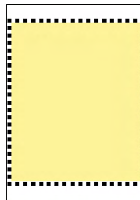
Methode 2: Ordnen Sie mehrere Patches in Kontrastfarbe entlang des Umfangs an.
