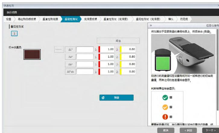
9. 将仪器放在适当位置以便测量第一个平铺并单击
