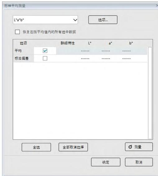
2. 反复将仪器放在要进行测量的标样上并单击标样平均测量对话框中的测量按钮以按指定次数执行测量。
