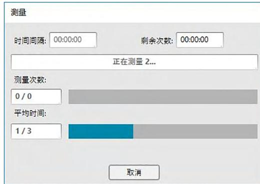
在进行标样数据的自动平均测量时，按指定次数重复测量。所有指定的测量完成时，对收集的测量数据求平均值并将其作为一个标样添加至文档。
