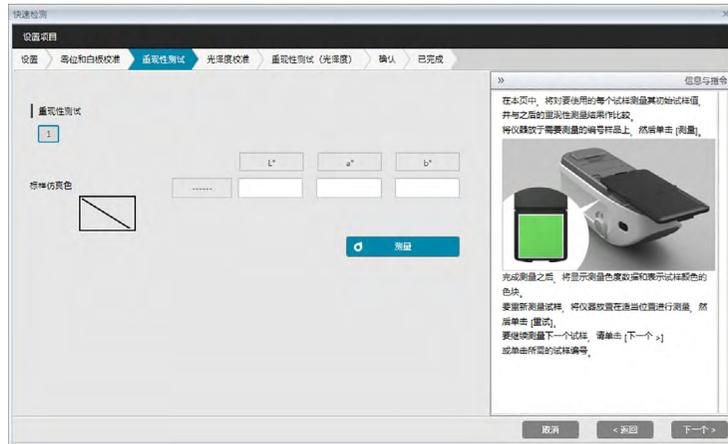
8. 将仪器放在适当位置以便测量第一个平铺并单击 **测量**。将执行在项目创建时为自动平均次数指定的测量次数，将显示平均测量结果且仿真色标将变为平铺的颜色。
