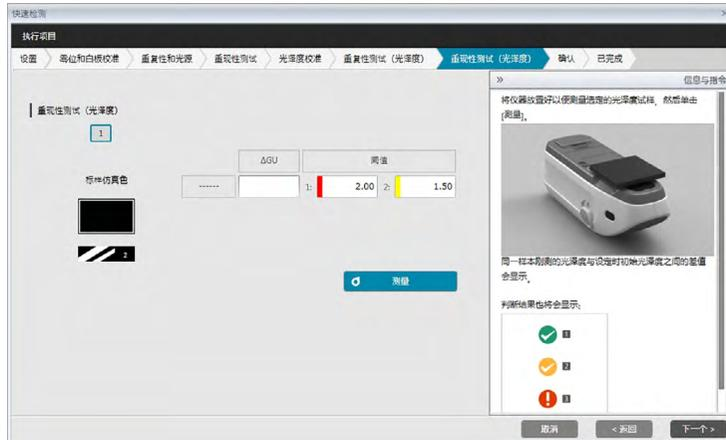
15. 将仪器放在第一个光泽度标准上并单击
