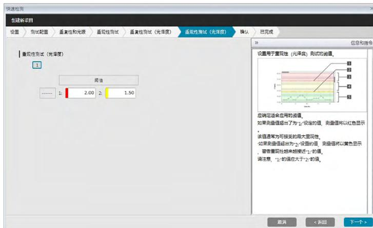
18. 选择用于光泽度重现性测试的每个平铺的重复性测试 (光泽度) 阈值。可为其设置阈值的平铺数量为步骤 8 中设置的试样数量。单击平铺数量以设置该平铺的阈值，或单击 [ 下一个 ] 以继续设置下一个平铺。范围：0.00 至 99.99
