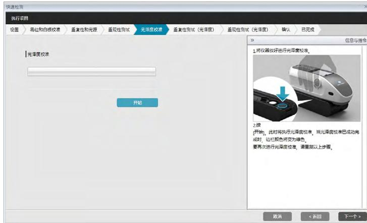
11. 将仪器放在适合进行光泽度校准的位置并单击 [ 开始 ]。将执行光泽度校准（进度条将显示进度），当光泽度校准完成后，该进度条将变为绿色且显示“光泽度校准完成”。
