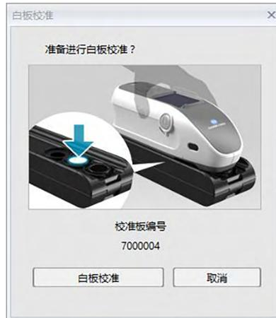
3. 如图所示，将仪器放在适合进行白板校准的位置，并单击 [ 白板校准 ] 以执行白板校准。
