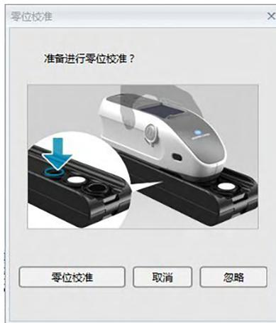
2. 如图所示，将仪器放在适合进行零位校准的位置，并单击 [ 零位校准 ] 以执行零位校准。
