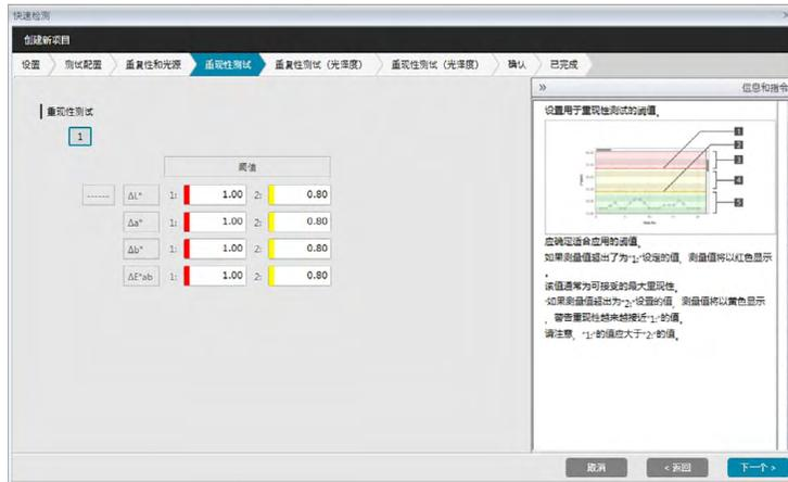
14. 选择用于重现性测试的每个平铺的重现性阈值。可为其设置阈值的平铺数量为步骤 8 中设置的试样数量。单击平铺数量以设置该平铺的阈值，或单击 [ 下一个 ] 以继续设置下一个平铺。范围：0.00 至 99.99
