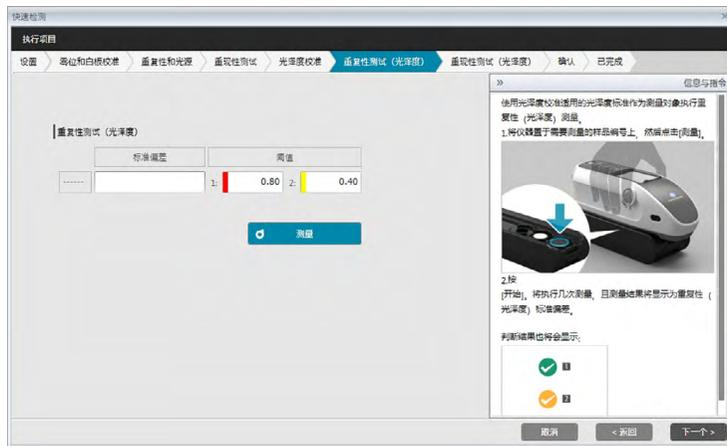
13. 将仪器放在适合进行白板校准的位置后，单击
