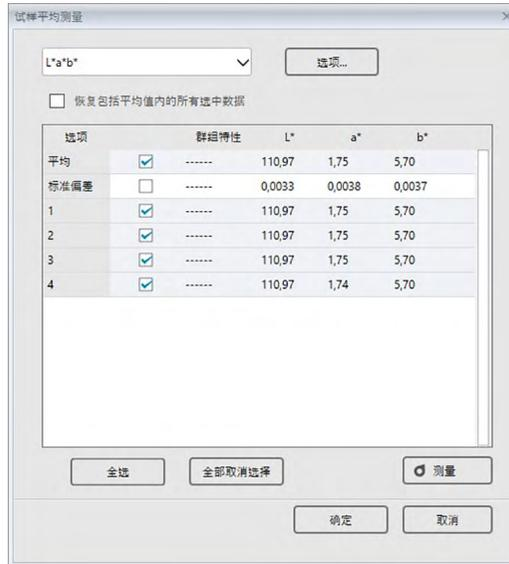
每次测量后将在对话框中显示测量数据，计算并显示当前执行的测量平均值和标准偏差。
