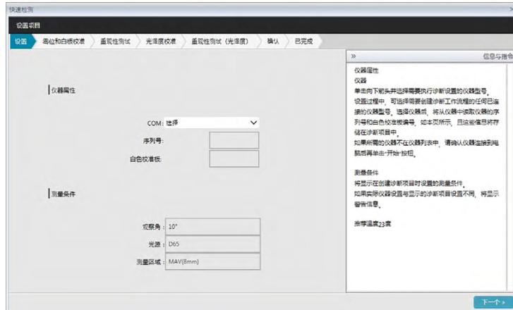
3. 单击 COM 端口设置旁边的向下箭头并选择要初始化项目的仪器所连接的 COM 端口。连接成功后，将显示仪器的序列号及其白色校准板。
