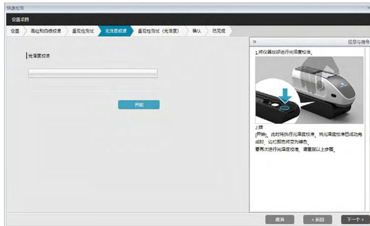
10. 将仪器放在适合进行光泽度校准的位置并单击 [ 开始 ]。将执行光泽度校准（进度条将显示进度），当光泽度校准完成后，该进度条将变为绿色且显示“光泽度校准完成”。
