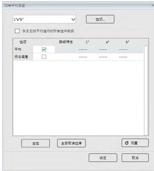
2. 反复将仪器放在要进行测量的试样上并单击试样平均测量对话框中的测量按钮以按指定次数执行测量。
