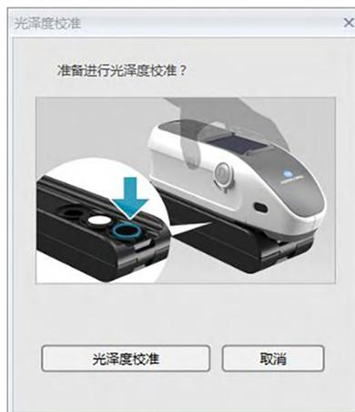
4. 如图所示，将仪器放在适合进行光泽度校准的位置，并单击 [ 光泽度校准 ] 以执行光泽度校准。
