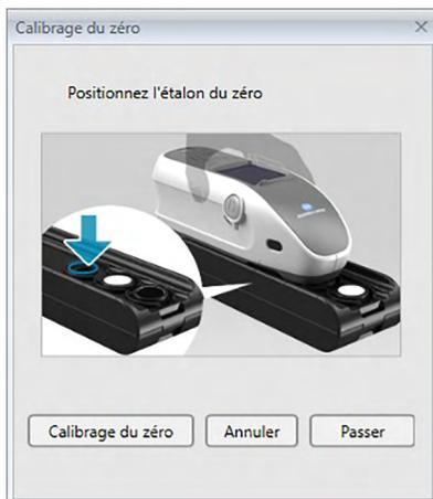
2. Positionnez l'instrument comme indiqué pour le calibrage zéro et cliquez sur [ Calibrage zéro ] pour réaliser le calibrage zéro.
