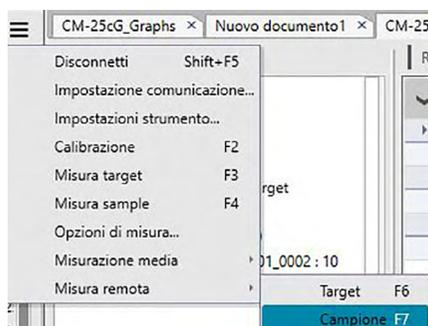
La misura remota del campione sarà abilitata e la Misura remota della scheda Info strumento della finestra Strumento cambierà in "Campione".
