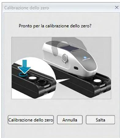
2. Posizionare lo strumento come mostrato per la calibrazione dello zero e fare clic su [ Calibrazione dello zero ] per eseguire la calibrazione dello zero.
