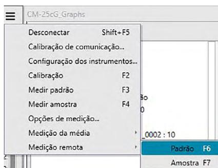
A medição remota do padrão será habilitada e a *Medição remota* guia Informações sobre o instrumento da Janela do Instrumento será alterada para “Padrão”.
