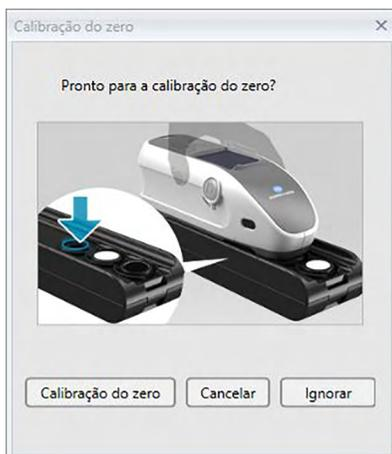
2. Posicione o instrumento conforme demonstrado para a calibração do zero e clique em [ Calibração do zero ] para realizar a calibração do zero.
