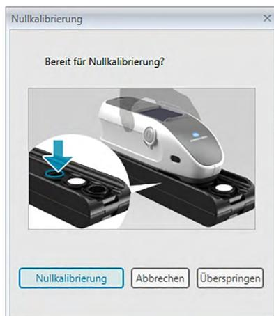
2. Positionieren Sie das Messgerät wie gezeigt für die Nullkalibrierung und klicken Sie auf [ Nullkalibrierung ], um die Nullkalibrierung durchzuführen.
