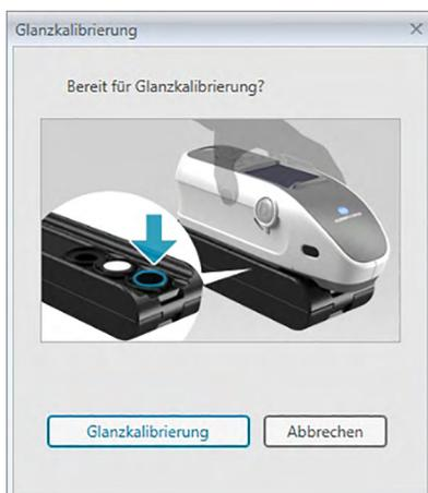
4. Positionieren Sie das Messgerät wie gezeigt für die Glanzkalibrierung und klicken Sie auf [ Glanzkalibrierung ], um die Glanzkalibrierung durchzuführen.
