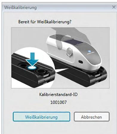
3. Positionieren Sie das Messgerät wie gezeigt für die Weißkalibrierung und klicken Sie auf [ Weißkalibrierung ], um die Weißkalibrierung durchzuführen.
