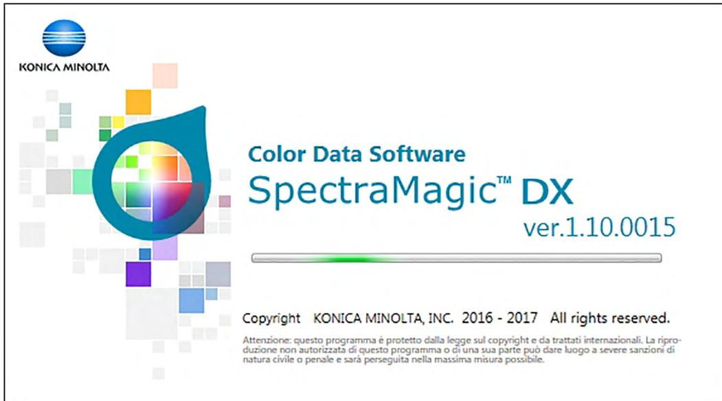
2. Trascorsi pochi secondi, la schermata scompare e l'area del pannello SpectraMagic DX mostrerà solo la barra degli strumenti del menu del pannello dei dati.
