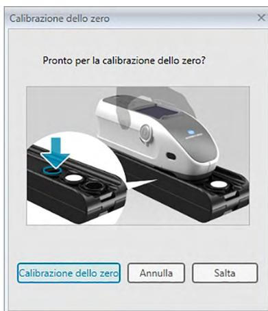
2. Preparare lo strumento per la calibrazione dello zero e fare clic su [ Calibrazione dello zero ] per eseguire questa funzione.
