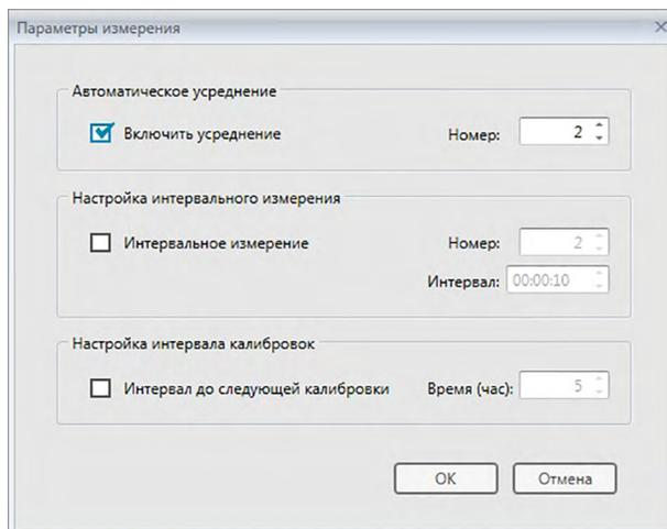
2. Чтобы включить автоматическое усредненное измерение данных образца, установите флажок «Включить усреднение».
