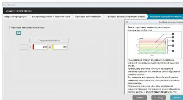
18. Выберите пороговые значения «Проверка воспроизводимости (блеск)» для каждой эталонной модели, которые будут использоваться в проверке воспроизводимости (блеска). Количество эталонных моделей, для которых можно задать пороговые значения, будет количеством образцов, заданных в шаге 8. Для перехода к следующей эталонной модели щелкните номер эталонной модели, чтобы задать для нее пороговое значение или нажмите кнопку [ Далее > ]. Диапазон: от 0,10 до 20,00
