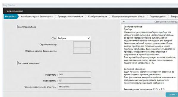
3. Щелкните стрелку вниз рядом с настройкой COM-порта и выберите COM-порт, к которому подключен прибор, который необходимо инициализировать для проекта. После успешного подключения прибора отобразятся его серийный номер и белая калибровочная пластина.
