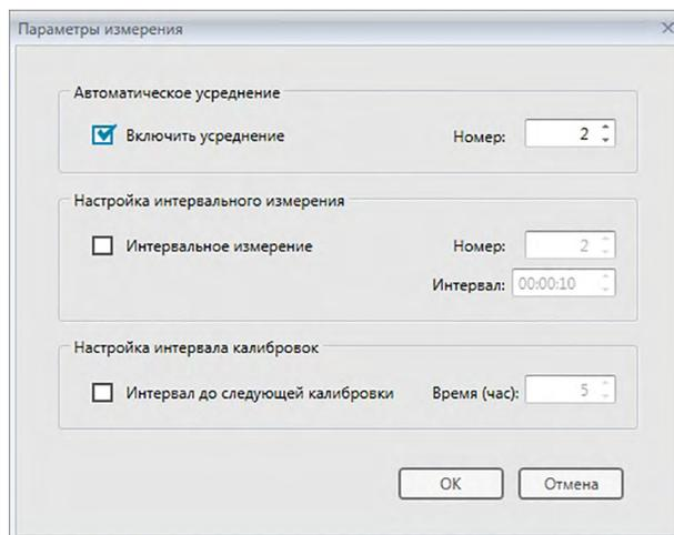
2. Установите флажок «Включить усреднение» и задайте параметры для «Автоматическое усреднение».
