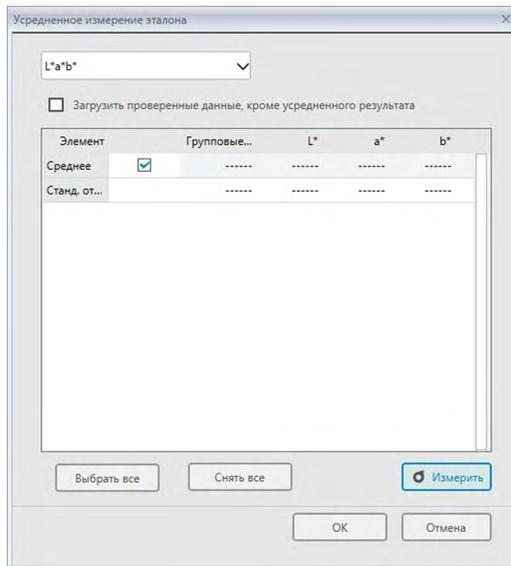
2. Периодически помещайте прибор на эталон, чтобы выполнить измерение, затем в диалоговом окне «Усредненное измерение эталона» нажмите кнопку [ Измерить ], чтобы выполнить требуемое количество измерений.
