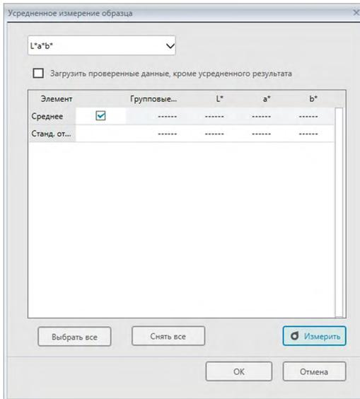
2. Периодически помещайте прибор на образец, чтобы выполнить измерение, затем в диалоговом окне «Усредненное измерение образца» нажмите кнопку [ Измерить ], чтобы выполнить требуемое количество измерений.
