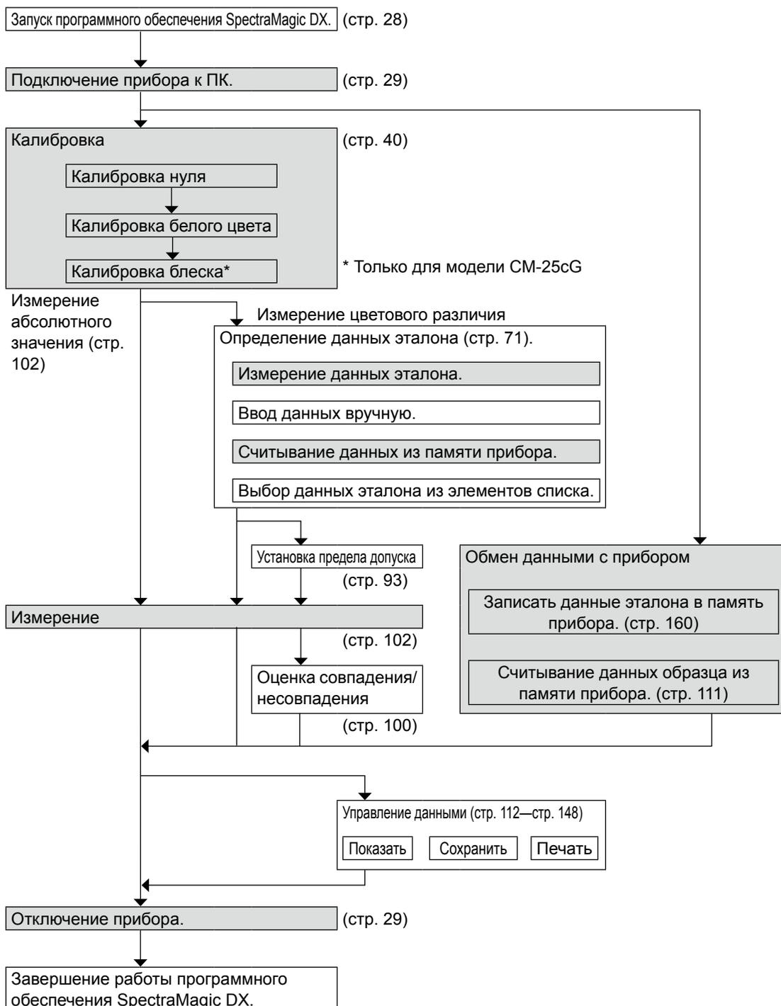
Затененные блоки обозначают функции, доступные только после подключения прибора и наличия действительной лицензии (электронной или ключа защиты, подключенного к компьютеру).
