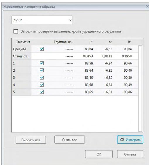
Данные измерений отображаются в диалоговом окне после выполнения каждого измерения, а также рассчитываются и отображаются среднее и стандартное отклонения выполненных измерений.
