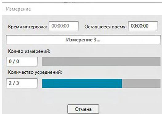
Во время автоматического усредненного измерения данных образца измерения повторяются заданное количество раз. После завершения всех заданных измерений полученные данные измерений усредняются и добавляются в документ в качестве одного образца.
