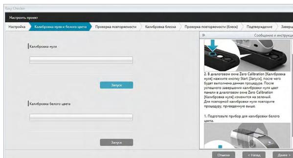
5. Подготовьте прибор к калибровке нуля и в разделе «Калибровка нуля» нажмите кнопку [ Запуск ]. После этого будет выполнена калибровка нуля (индикатор выполнения показывает ход выполнения процедуры), а после завершения этой процедуры цвет панели изменится на зеленый и появится сообщение «Калибровка нуля завершена.». Если во время создания проекта для калибровки нуля будет выбран пункт «Пропустить», можно приступить к калибровке белого цвета без проведения калибровки нуля.
