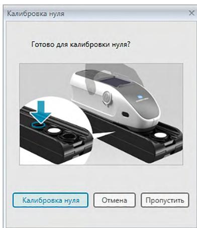
2. Подготовьте прибор к калибровке нуля и нажмите кнопку [ **Калибровка нуля** ], чтобы выполнить данную процедуру.
