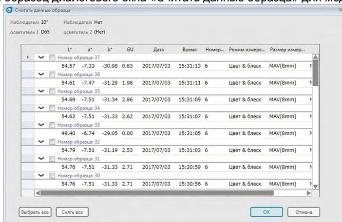
2. Выберите образцы, которые необходимо считать из памяти прибора в приложении SpectraMagic DX, установив флажок рядом с именем образца, чтобы отметить его.
