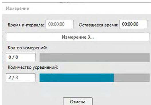
Во время автоматического усредненного измерения данных эталона измерения повторяются заданное количество раз. После завершения всех заданных измерений полученные данные измерений усредняются и добавляются в документ в качестве одного эталона.
