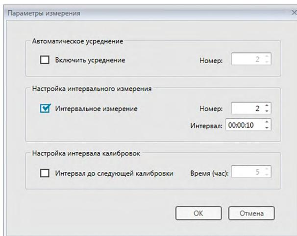
2. Проверьте интервальное измерение и задайте параметры для интервального измерения.
