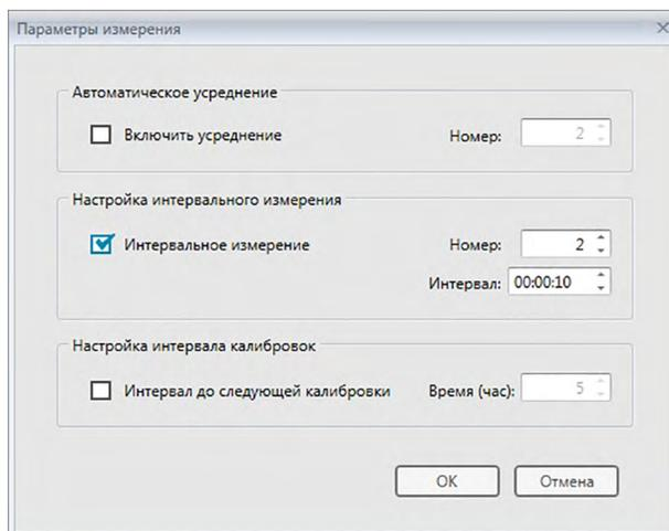
2. Проверьте «Интервальное измерение» и задайте параметры для «Настройка интервального измерения».
