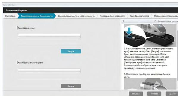
4. Подготовьте прибор к калибровке нуля и в разделе «Калибровка нуля» нажмите кнопку [ Запуск ]. После этого будет выполнена калибровка нуля (индикатор выполнения показывает ход выполнения процедуры), а после завершения этой процедуры цвет панели изменится на зеленый и появится сообщение «Калибровка нуля завершена.». Если во время создания проекта для калибровки нуля будет выбран пункт «Пропустить», можно приступить к калибровке белого цвета без проведения калибровки нуля.
