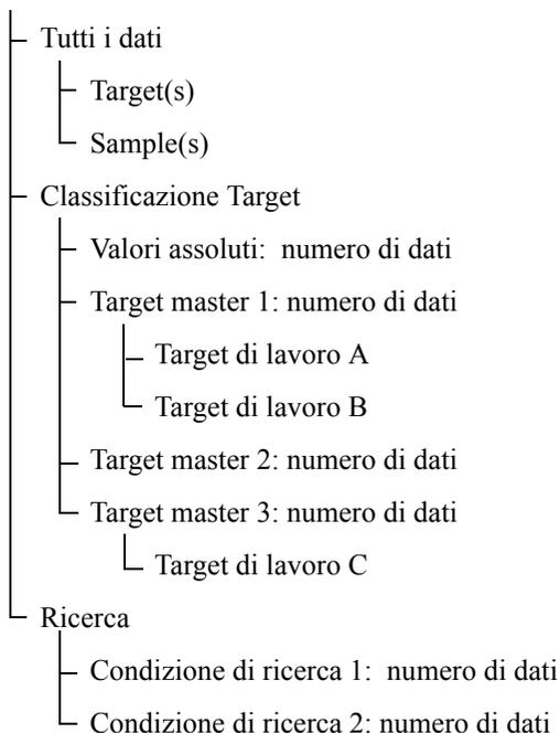
La cartella Classificazione Target contiene gruppi di dati suddivisi per target e un gruppo di dati non collegato a nessun target (ovvero i valori assoluti ottenuti dalle misurazioni). Quando si registrano i dati di un target, viene creato un nuovo gruppo “Target”. Creando invece un nuovo file, viene inserito un gruppo di dati denominato “Valori assoluti”.
