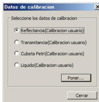
**2-2)** Cuando seleccione Reflectancia (Calibración por el usuario), seleccione el área de medición y el modo de componente especular que desea configurar.
