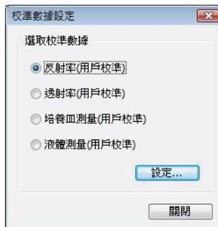
2-2. 選擇反射率 (用戶校準) 時，選擇要設定的測量區域及鏡面光。
