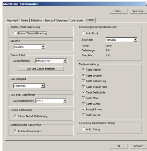
Durch Anklicken der Schaltfläche Laden können Sie eine vorhandene Umgebungseinstellungsdatei laden. Durch Anklicken der Schaltfläche Speichern können Sie die aktuellen Umgebungseinstellungen in einer Umgebungseinstellungsdatei speichern. Der Dateiname darf nur Zeichen enthalten, die am Gerät eingestellt werden können. Nähere Informationen finden Sie unter „Batch-Einstellung der Bedingungen“ in der Bedienungsanleitung des Geräts.
