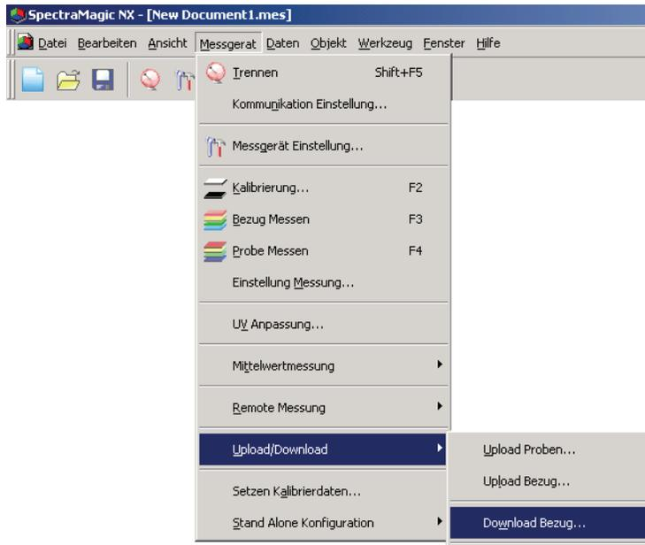
2. Stellen Sie die Details für die in das Messgerät geladenen Bezugsdaten ein.
