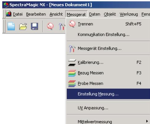
Während der automatischen Mittelwertmessung der Probedaten werden die Messungen so lange wie eingestellt wiederholt. Nach Beendigung der Messung wird für die Ermittlung eines Probenwerts ein Mittelwert der Probedaten gebildet.
