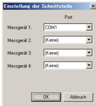
Wenn zwei oder mehr Geräte des Typs CM-700d/600d angeschlossen sind, werden der beim ersten Messgerät (Messgerät 1) eingestellte Glanz-Modus (SCI, SCE oder SCI+SCE) sowie der Messbereich (SAV (3 mm) und MAV (8 mm)) für alle weiteren angeschlossenen Messgeräte verwendet.
