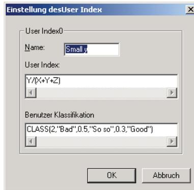
4. Wenn die OK-Taste gewählt wurde erscheinen einige Dialoge zur Bestätigung und der User Index wird zum Messgerät übertragen.
