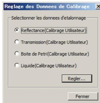
**2-2.** Après avoir sélectionné Reflectance Calibrage Utilisateur, sélectionnez la zone de mesure et le mode de composant spéculaire que vous souhaitez régler.
