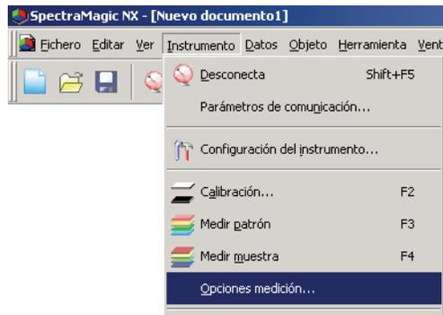
2. Especifique los parámetros para la medición autopromediante y el intervalo de calibración.
