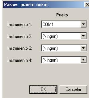
Cuando se conectan dos o más equipos CM-700d/600d, se aplican a los demás instrumentos conectados el modo de componente especular (SCI, SCE o SCI+SCE) y el área de medición (SAV [3 mm] y MAV [8 mm]) especificados para el primer instrumento conectado (instrumento 1).
