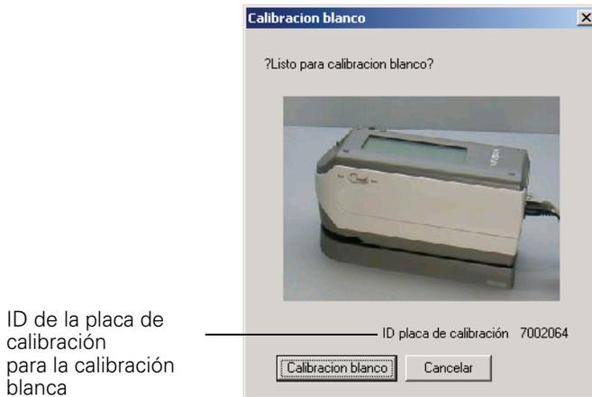
ID de la placa de calibración para la calibración blanca
