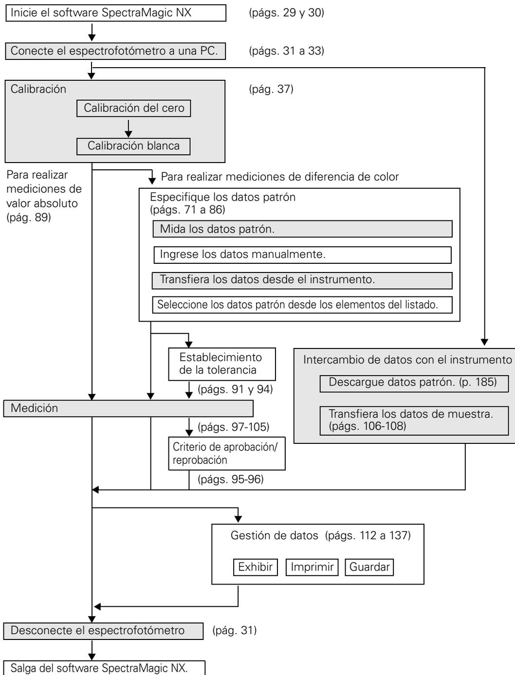
Las secciones sombreadas indican funciones disponibles solamente cuando el espectrofotómetro está conectado y la llave de protección se encuentra inserta en la computadora.
