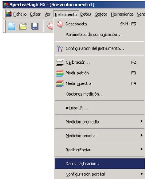
2. Especifique el valor de la calibración. El método varía según sea el conectado instrumento. Para obtener detalles consulte las páginas 168 a 170.
