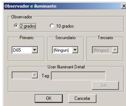
Sólo se pueden especificar un observador y un iluminante para cada fichero de documento. Esta configuración no afecta al observador y al iluminante que hayan sido especificados con el instrumento. Si el instrumento conectado es de la serie CR, especifique el observador y el iluminante que coincidan con el observador y el iluminante configurados para el instrumento.
