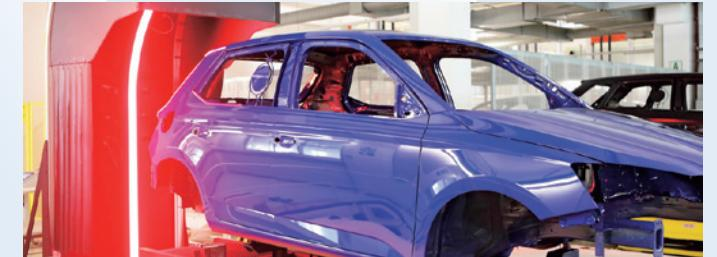
自動車の製造現場では、品質の向上や安定化、および省人化を目的に、生産工程の自動化ニーズが高まっています。なかでも、車体の外観検査は、ルーフから車体後方にいたるまでの塗装の微妙なキズ・ムラの検出が必要で、業界ではこの工程の自動化が望まれてきました。こうした声に応えるため、塗装欠陥の自動検査システムを提供。さらに、計測データを前工程である塗装工程や、後工程の補修工程にも活用するなど、工程全体を通じた、さらなる品質向上を目指しています。
