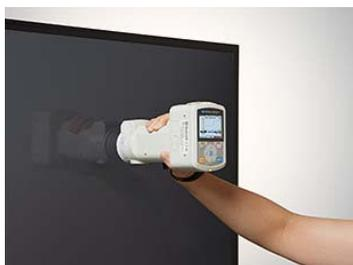
電化製品や情報機器の外装、周辺パーツ類の色管理が可能です。さらにディスプレイのARコート(反射防止膜)やTACフィルム、反射型液晶の反射率測定も行えます。特定波長を管理することでARコートのバラつき低減を実現します。
