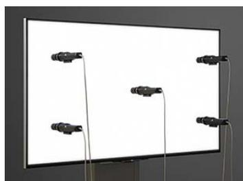
生産ラインの現場での有機ELやLEDテレビ、スマートフォンの色の調整・検査・品質管理が可能。さらにホワイトバランス・ガンマ・コントラスト・フリッカ調整も高精度かつ高速測定を実現します。
