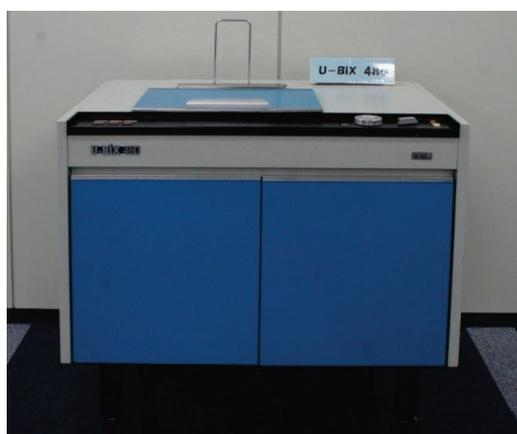
小西六写真工業の最初のPPC複写機（普通紙複写機）であるU-Bix 480は、1970年にビジネスショーで発表、1971年1月に発売されました。国産技術による最初の間接乾式電子写真複写機として、また、優美な画質に加えてコピーコストが従来の半額という低価格が大きな反響を呼び、生産が需要に追い付かないほどの好評を博しました。これ以後、複写機はカメラ、フィルムと並ぶ主力製品となっていきます。
