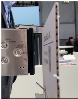
ハイギャップ印刷では段ボール表面が 均一でなくてもクリアな印字が可能
