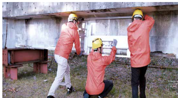
橋梁の内部鋼材破断を可視化する非破壊検査の様子
