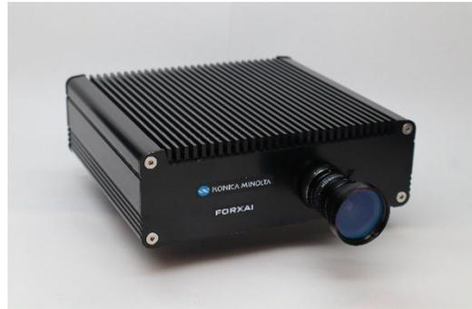
今回の実験に使用した低遅延カメラは、5Gに対応しているほか最大4Kの高精細映像の伝送が可能で、なおかつ映像伝送の遅延を50～70ミリ秒(0.05～0.07秒)に抑えています。このシステムを活用すれば、建設機械だけでなく、あらゆる機械で遅延の無い遠隔操作が期待でき、工事現場や工場などの省力化および安全性の向上に大きく貢献するものと考えています。今後は、早期実用化に向けて開発をさらに加速させていきます。
